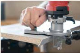
Dank großer Auflagefläche lassen sich selbst schräge Kanten sicher bearbeiten.
