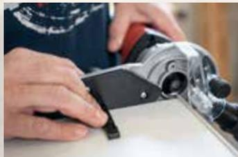
Für die Eckbearbeitung bietet der einsteckbare Anschlag eine sichere Führung.
