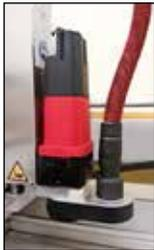
Die Befestigung ist über den Spannhals oder alternativ über eine direkte Verschraubung am Portal möglich.
